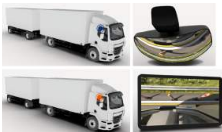
รูปที่ 2.2- 20 ROOF MIRROR (CLASS V)
