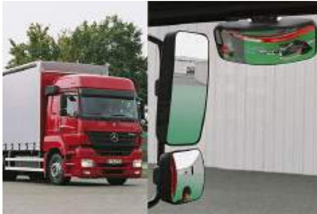
รูปที่ 2.2- 13 Wide-angle and blind spot mirrors
