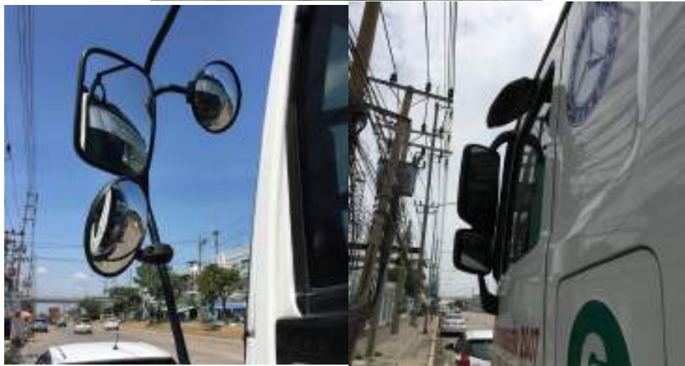
รูปที่ 3- 2 ลักษณะการติดตั้งกระจกมองข้าง
