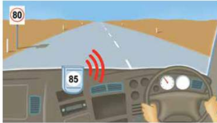
รูปที่ 2.2- 49 Intelligent Speed Adaptation (ISA) Warning System
