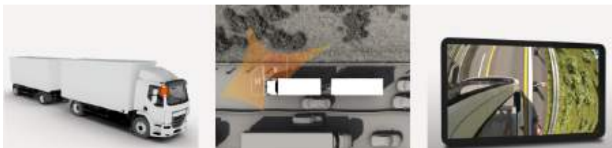
รูปที่ 2.2- 21 CAMERA ON THE A-PILLAR (CLASSES V AND VI)
