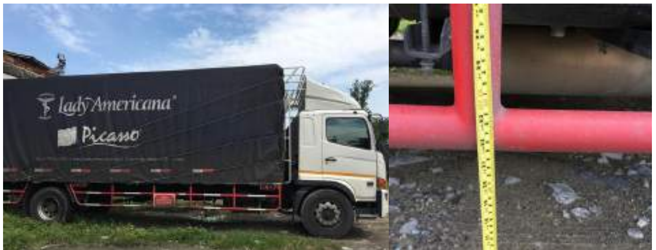
รูปที่ 3- 3 Under-run Guard ด้านข้างสูงจากพื้น 55 เซนติเมตร
