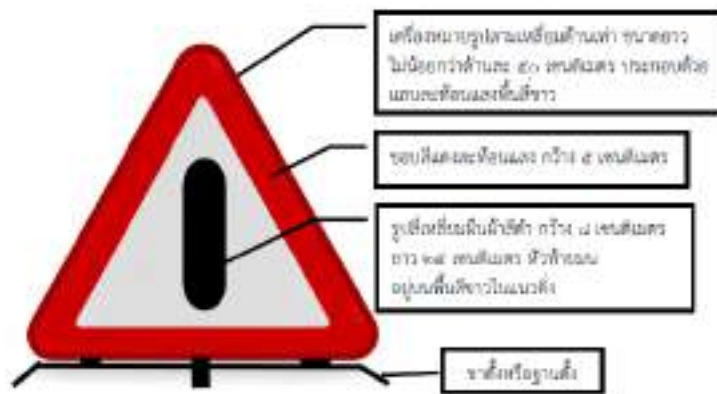
รูปที่ 2.1- 2 เครื่องหมายเตือนรูปสามเหลี่ยมด้านเท่า แบบที่1
