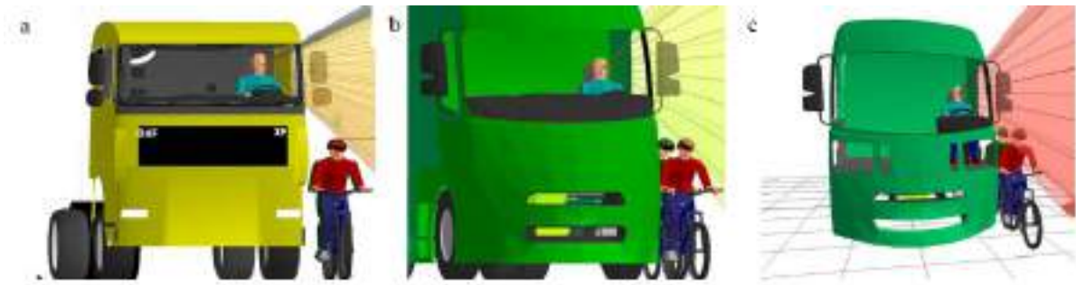
รูปที่ 2.2- 10 Driver's side visibility of cyclists
