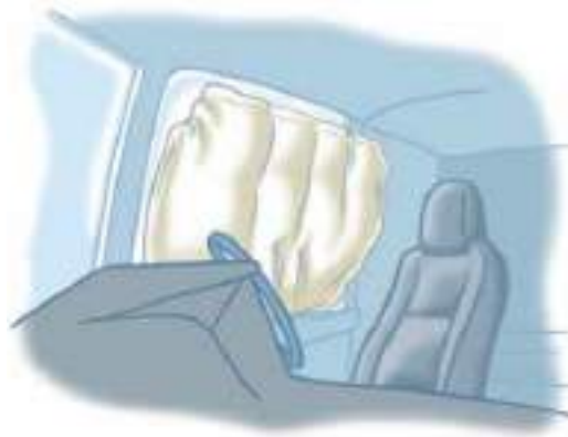
รูปที่ 2.2- 47 Rollover Side Curtain Airbag
