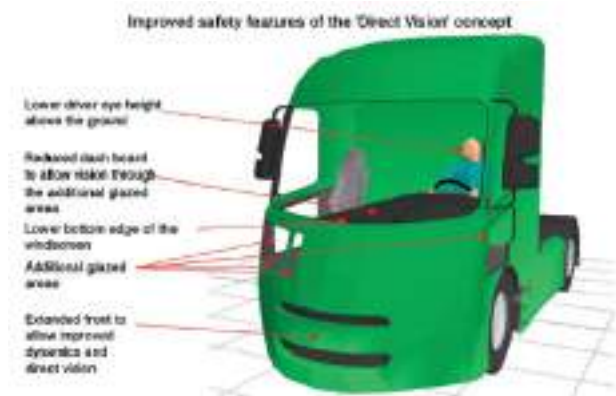
รูปที่ 2.2- 5 การออกแบบห้องโดยสารให้โปร่งใสเพื่อการมองเห็นโดยตรง
