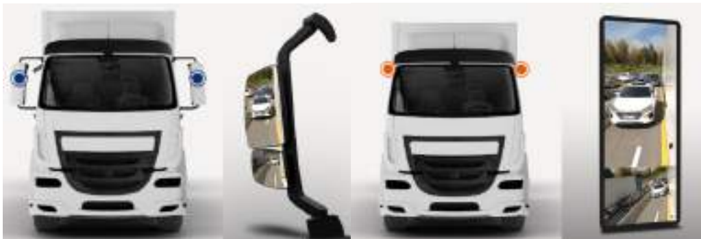
รูปที่ 2.2- 18 MAIN AND WIDE-ANGLE MIRRORS (CLASS II AND CLASS IV)
