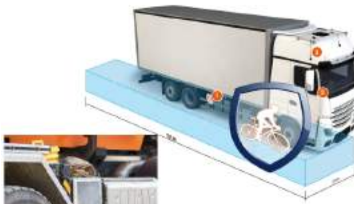
รูปที่ 2.2- 22 ระบบ Turn Assist System AAS
