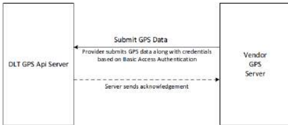
รูปที่ 5.6-10 รูปแบบการส่งข้อมูลเข้าสู่ DLT GPS API Server
