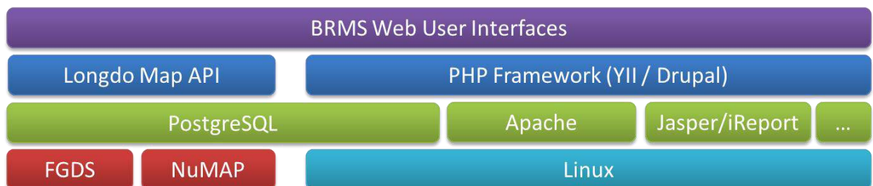
รูปที่ 5.1-3 องค์ประกอบพื้นฐานของระบบ BRMS
